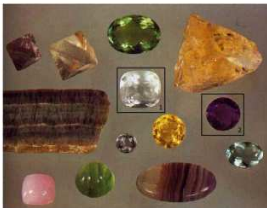
Figure 8 : Cristaux de fluorine \text{CaF}_2 . La grande variété de couleur observée est liée à l'existence de défauts ponctuels (lacunes, impuretés substitutionnelles) ou association de défauts ponctuels (inclusions d'ions moléculaires). Les cristaux purs et exempts de défauts sont transparents (1). La fluorine violette doit sa couleur à la présence de lacunes sur les sites habituellement occupés par le fluor (2). Les autres couleurs s'expliquent par la présence d'impuretés chargées, sous forme d'ions simples ou moléculaires.
